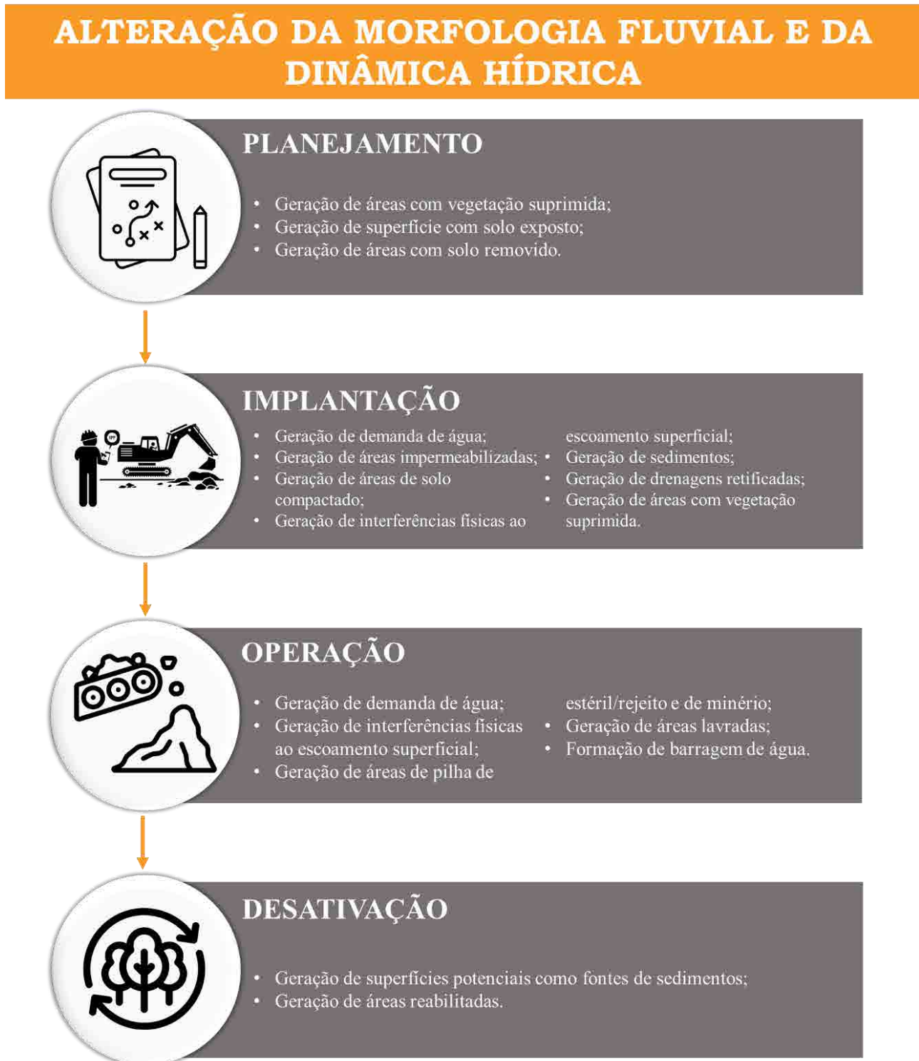
Figura 08 Fluxograma de Avaliação do Impacto Ambiental da Alteração da Morfologia Fluvial e da Dinâmica Hídrica
